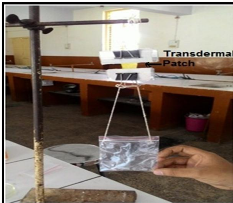
Fig No2.1.: Modified Tensile Strength Apparatus.
